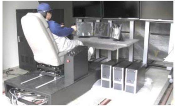
図7 反力生成装置付きシミュレータ (FHI製作中)
