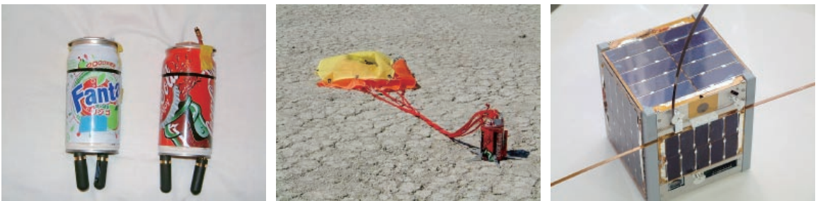
図1 教育用衛星としての東京大学のCANSATおよびCubeSatの1号機XI-IV
