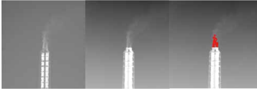
(a) 遠赤外画像 (b) 中赤外画像 (c) 融合処理後の画像 図7 煙突の排気ガスを2融合処理により抽出した画像 9)
