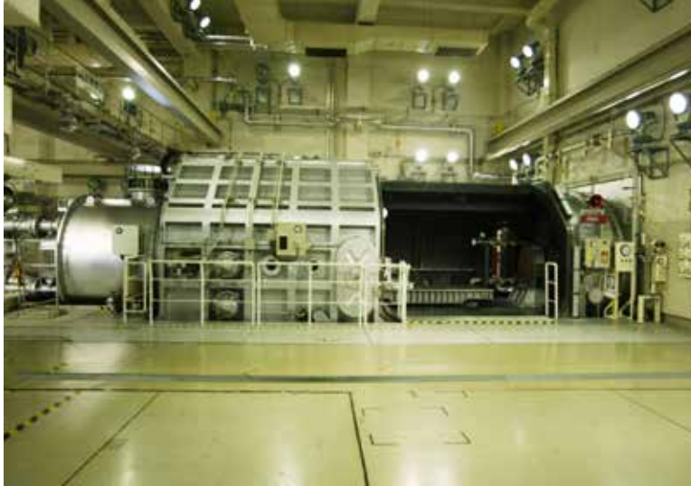
燃焼風洞（出典：防衛装備庁 札幌試験場）
