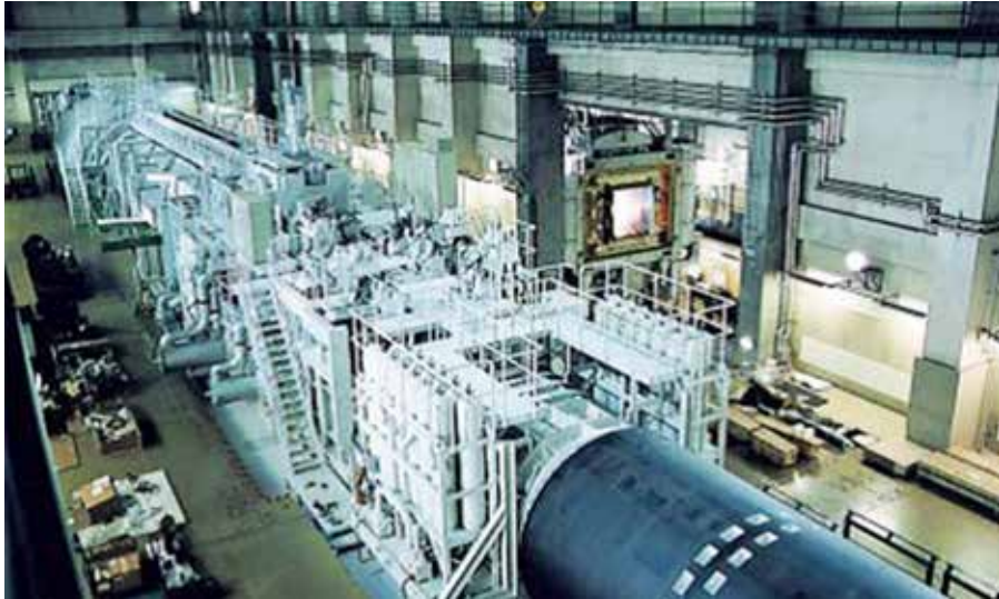
三音速風洞の試験計測棟内部（出典：KHI） 左奥から集合筒・可変ノズル・測定部・拡散筒と並んでいる
