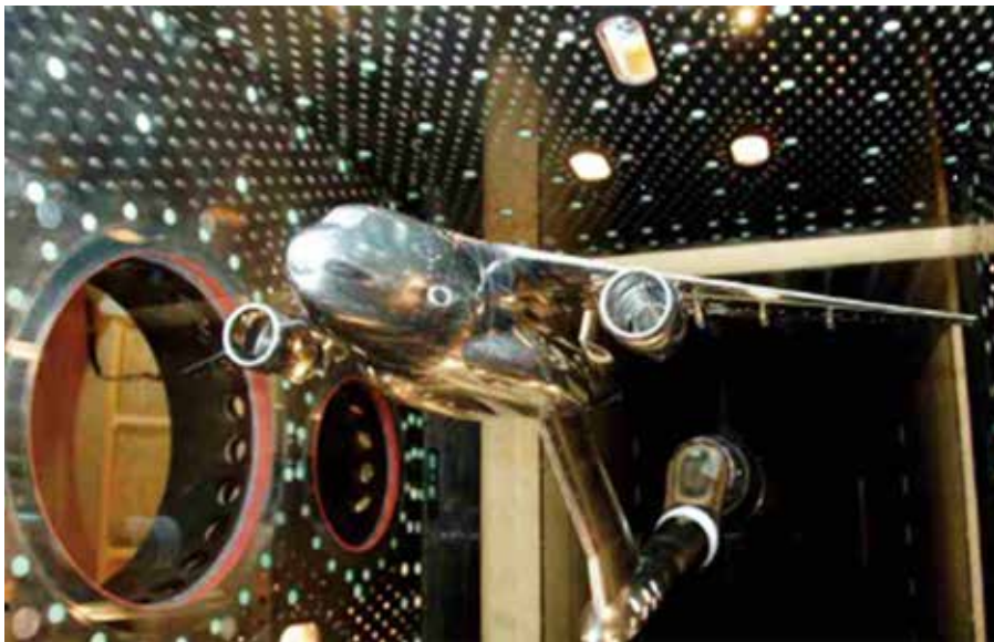
三音速風洞の測定部（出典：防衛装備庁 札幌試験場）
