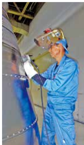
若杉氏 液体ロケットエンジンノズルスカートの溶接作業
