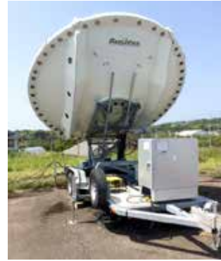
衛星通信アンテナ
