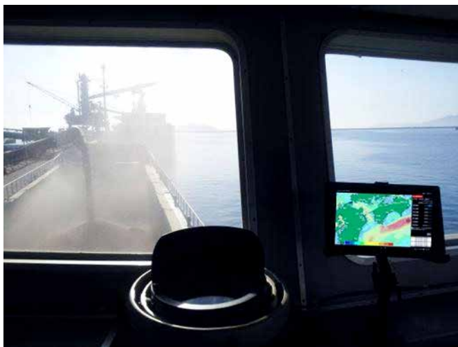
図7 本船に搭載された潮流海流予測情報表示端末
