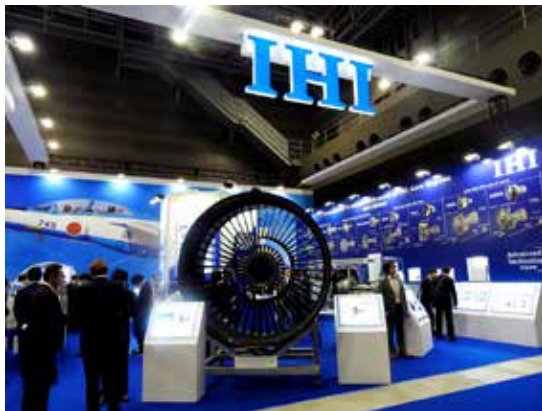
IHIが展示したピュアパワーPW1100G-JMのCFRPファンケースとCFRP構造案内翼SGV。
