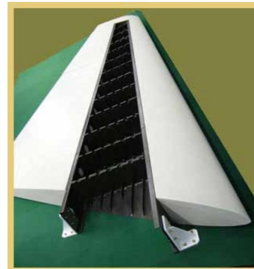
Mitsubishi SpaceJet 用複合材垂直尾翼主桁 (実大試験供試体)
