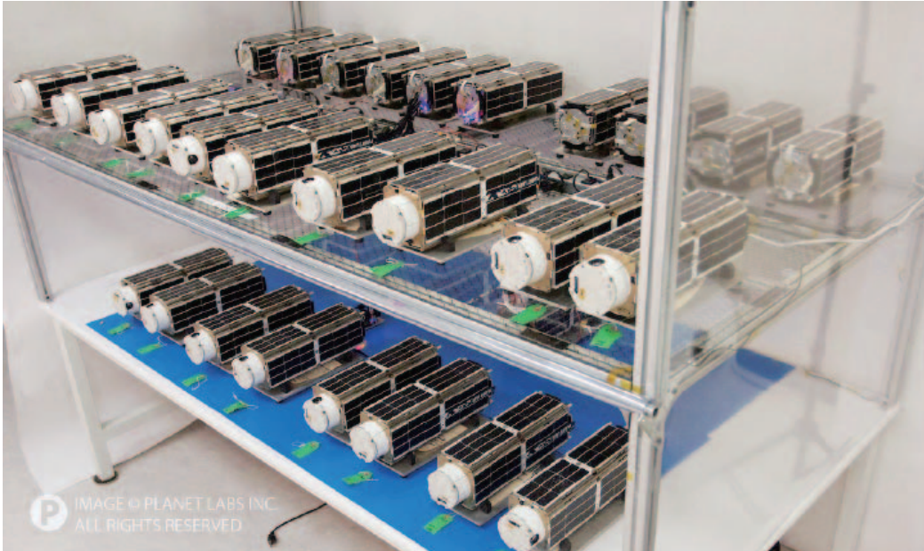
図4 PlanetLabs社のDove製造状況 ( https://www.planet.com/flock1/ )
