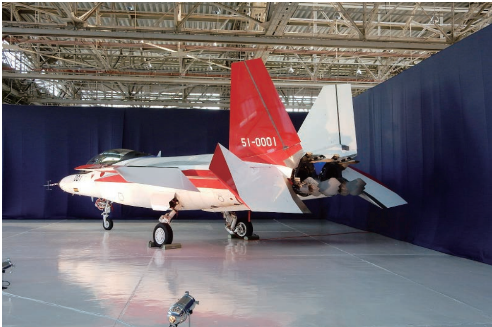
先進技術実証機には搭載エンジン1基につき3枚の推力偏向パドルが備わっている（筆者撮影）
