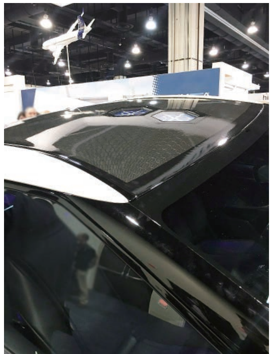
写真1 会場入り口（左）とKymetaの車載埋込みアンテナ（右）
