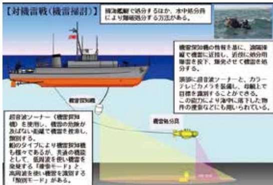
機雷の種類と処分の方法 防衛省HP、海上自衛隊・掃海隊群のページから引用
