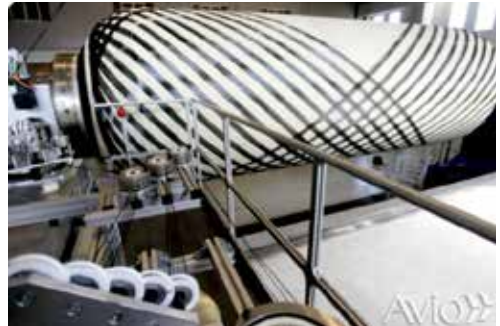
白色のマンドレルに黒色の炭素繊維を巻きつけてモータケースを製造（出典：AVIO社）
