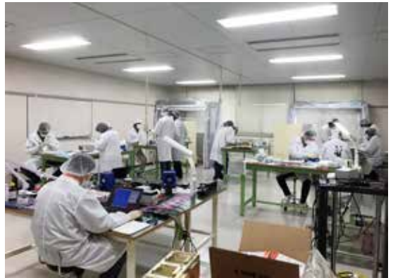
図5 九工大での衛星5基の同時組み立て。各機で1UCubeSatが一個ずつ組み立てられている。
