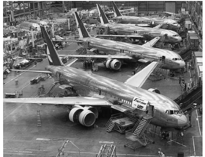
ボーイング社エバレット工場で組立中の767旅客機
