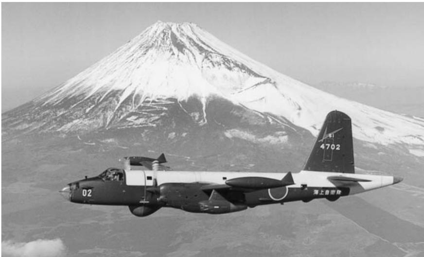
P2V-7は当時の最新鋭の対潜哨戒機であり、対潜作戦に初めてコンピューター処理技術を導入した機体である。P2V-7はレシプロ機とはいいながら、3,750 hpのライトR3350エンジンと補助エンジンとして推力1.54tのウェスチング・ハウスJ34ジェット・エンジンを
