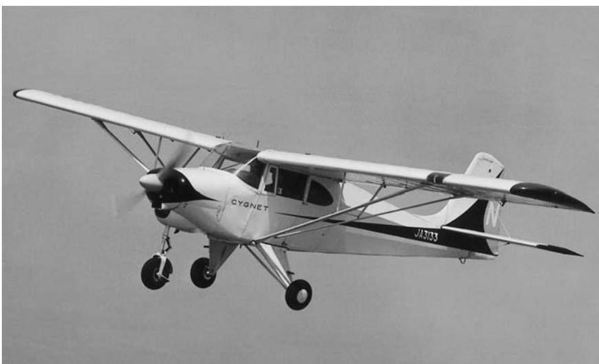
木村研究室が所有するハイパー・トライペーサをベースに日本の国情にあった軽STOL(Short Take off Landing)機に改造することを目標に、日本大学機械科航空専修コース木村研究室が設計を、伊藤忠航空整備(現新日本航空整備)技術部が詳細設計及び製作を担
