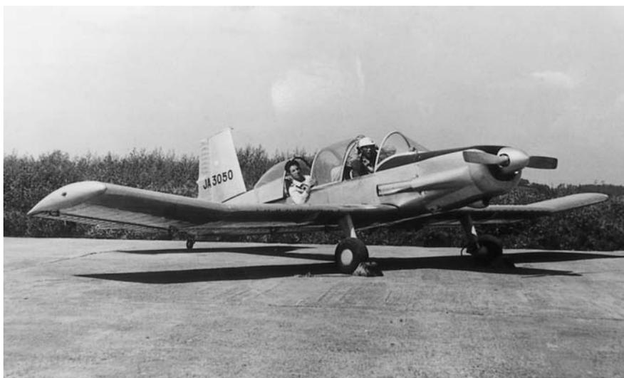
アメリカのフレッチャ社の設計した機体を東洋航空がライセンス生産した全金属製の軽快な小型機。構造が簡潔で維持整備が容易であり、徹底した軽量化が図られている。尾翼、動翼には小骨がなく、胴枠はわずか3個しかない。複座練習機型のA型と単座攻撃機
