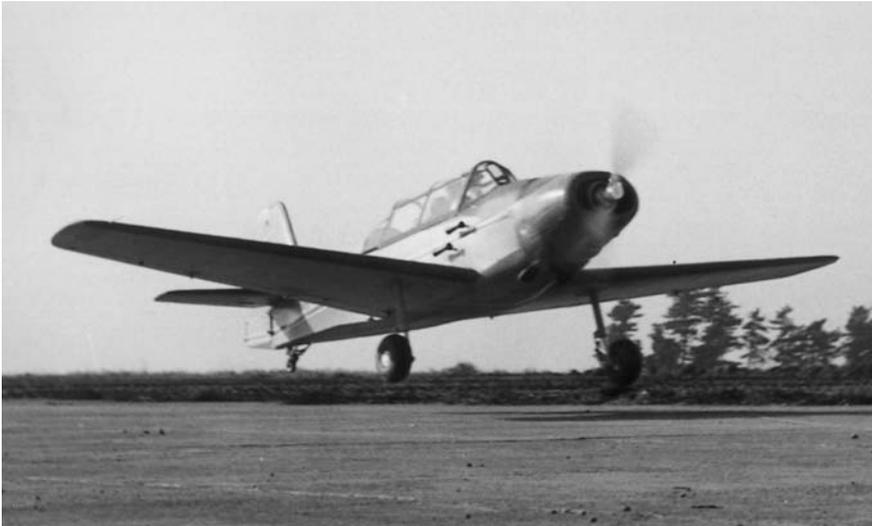
旧川西航空機の技術者らが主力になって設立した東洋航空が製作した練習機。昭和27年8月に設計に着手し、同年12月に完成、同30日に初飛行した。設計は、馬場敏治技術部次長が主務者となり、耐空性基準の実用Uに適合する機体として製作した。
