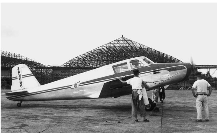
川崎航空機（現川崎重工）が戦後はじめて自主開発した軽飛行機で、全金属引込脚構造という本格的な飛行機の製作であり、戦後の長い技術的な空白と資材難を克服してようやく作り上げた。本機の計画は昭和27年6月ごろにスタートし、同年9月から設計を開始
