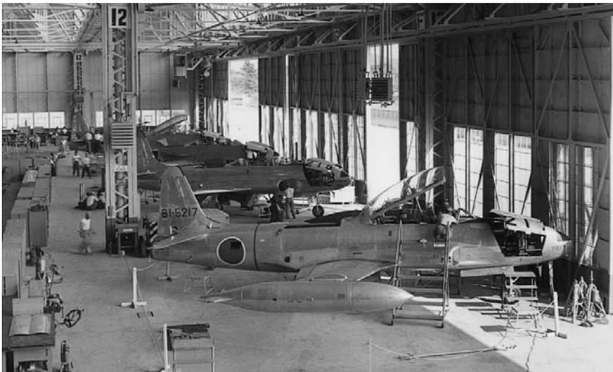
T-33は、1943年6月から開発が開始されたアメリカ初の制式ジェット戦闘機P-80から発達した機体である。その原型XP-80は1944年1月8日に初飛行、1947年8月に生産中のF-80Cの胴体を延長して複座練習機とすることが決まり、TF-80Cと名づけられて1948年3月22日に初飛行、以後の生産機は全機複
