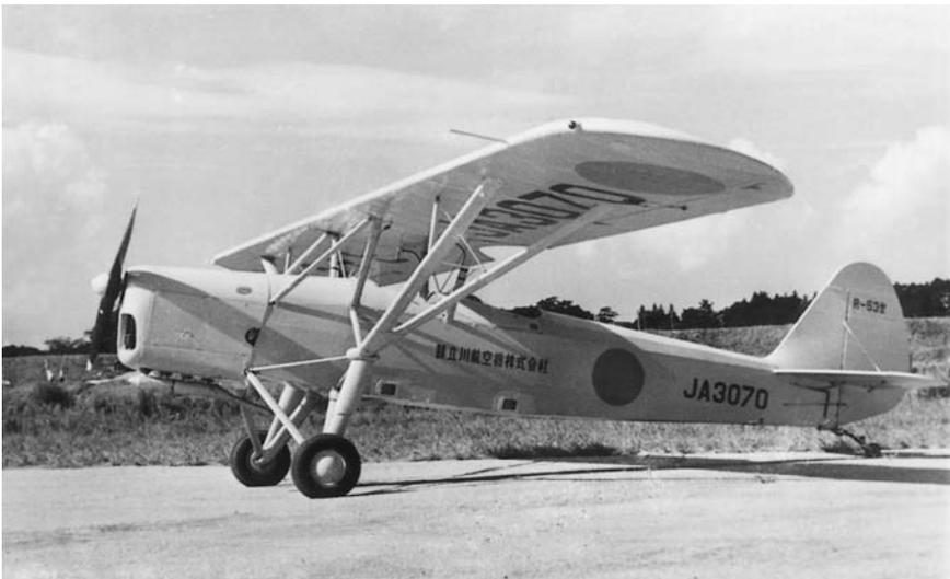
応急的に製作したR-52練習機に次いで、新立川飛行機が約2年近く遅れて設計・製作しただけあって、前者の経験が広くとりいれられた練習機となった。機体の基本的な形態は前者と同様だが、主翼位置を下げ、エンジンをイギリス製直列倒立4気筒のシーラス・
