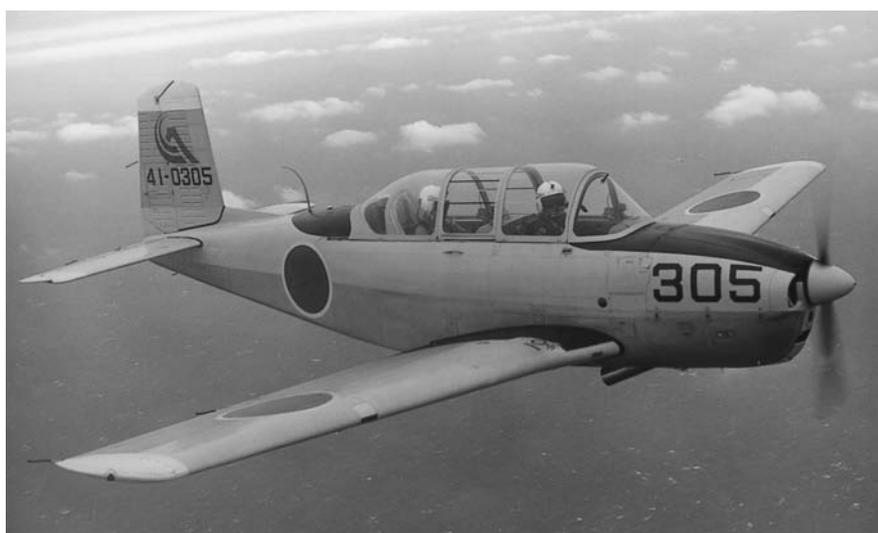
ビーチ・クラフト社の傑作小型機「ボナンザ」から発展した初等練習機T-34メンターを富士重工がライセンス生産したもので、防衛庁向けへ124機、外国向けに37機生産された。航空機生産再開後の量産1号の荣誉を担った本
