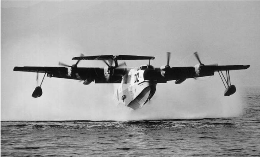
昭和30年代前半に、官民共同の研究会が開催されソーナーを使用した対潜飛行艇の構想が検討された。この構想を実現するためには、飛行艇の弱点である対波浪性の向上、離着水速度を低くするための高揚力装置の実現等複雑な技術的課題を解決する必要があった。この技術的課題を解決するため、米海軍から供与されたグラマン アルバトロスを改造したUF-XS実験機を用いて、昭和39年まで実施した各種の試
