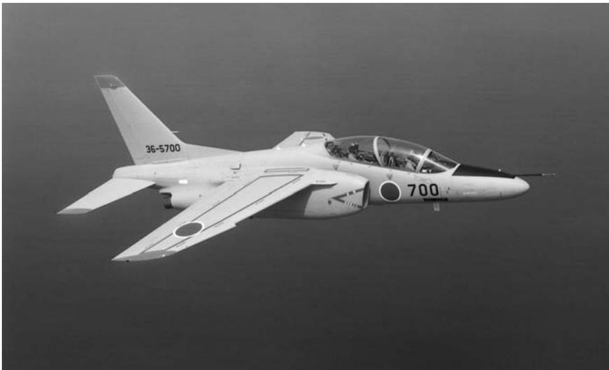
T-4中等練習機は機体・エンジンとも国内開発したほか、種々の新技術が盛り込まれている。初等練習機から高等練習機への移行がスムーズに行えるよう、遷音速翼の採用のほか、機体形状に工夫をこらし、低速から高速まで広い飛行範囲で良好な飛行特性を持つよう設計されている。設計開始時からコスト・コントロール活動を行い、
