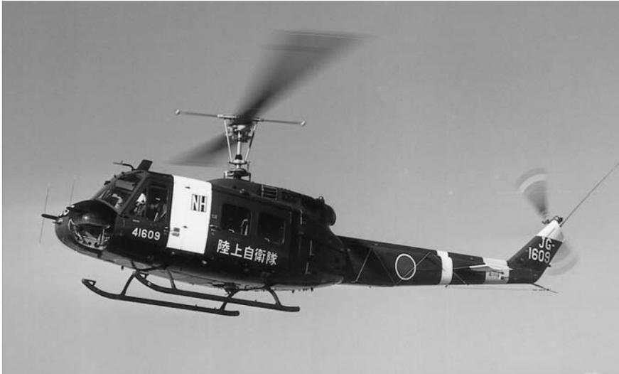
米陸軍の多用途ヘリコプターとして開発されたUH-1（ベル204/205）系列を富士重工がライセンス生産した。陸上自衛隊のほか、民間の多用途ヘリコプターとして使用されている。本機的设计思想と機体構造は中型ヘリコプターの最も標準的なものとして、以後の
