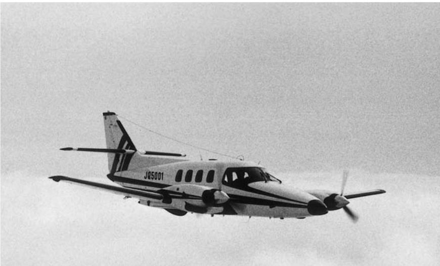
富士重工が米国ロックウエル・インターナショナル社と共同開発した6~8人乗りレシプロ双発ビジネス機である。ジェット機なみに大型鍛造品を多用しているところに特徴がある。昭和50年11月に初飛行に成功した。FA-300
