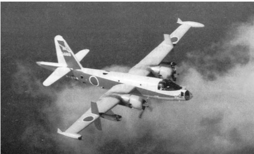
防衛庁技術研究本部の第3研究所で行った可変特性の研究を実験するための研究機 (Variable Stability Aircraft : VSA)。川崎重工が昭和51年からP2V-7対潜機を改造し、昭和51年に初飛行し、その後海上自衛隊が飛行試験を行った。
