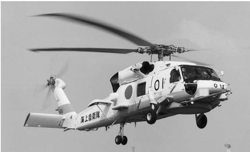
この新対潜ヘリコプター（艦載型）システムは、アメリカから導入する対潜ヘリコプター（SH-60B）の機体に、防衛庁技術研究本部が開発したソナー、ソノブイ、磁気探知装置、レーダーなどから得られる戦術情報などをコンピューターによって自動的に処理す
