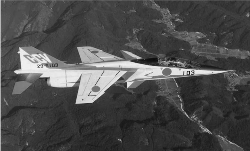
防衛庁技術研究本部が将来戦闘機開発に必要な要素技術の研究を実施するために試作したCCV (Control Configured Vehicle) 試験機。操縦装置 (Control) が形造った (Configured) 機体 (Vehicle) であり、コンピューターが常に最適条件を保持するため、パイロットの負荷
