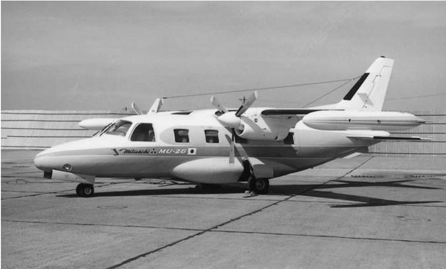
三菱重工が独自に開発したビジネス用双発ターボプロップ機。世界の市場、特に米国での販売を視野に入れ、商品としてアピールする特徴を持たせる観点から設計が進められた。結局オーソドックスな高翼双発形式が採用され、外形は常識的なものに落ち着いたが、独創的な構造、技術が採用されている。
