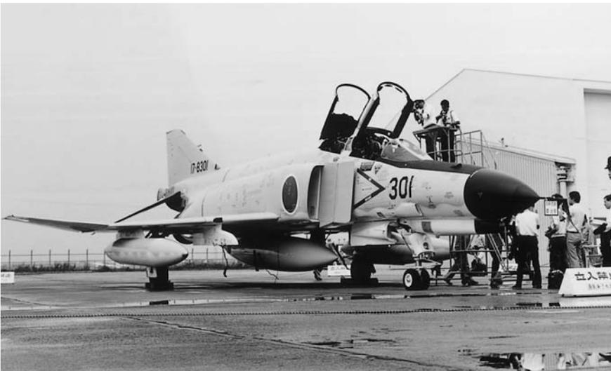
昭和42年から開始された数次の調査団の調査結果を踏まえ、昭和43年にF-104戦闘機の後継としてF-4EJを機種決定した。F-4EJは米軍が運用するF-4Eを基本として日本型としたものである。レーダ警戒装置APR-37はリリースされないため国産のJ/APR-2を、更に日本バッジに適合した国産データ・リンク装置N/APR620を搭載している。又国会で問題視された爆撃標準装
