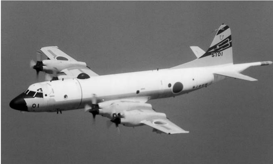
P2V-7の後継機として開発された大型対潜哨戒機で、ロッキード社のターボプロップ4発旅客機エレクトラを母体として発展させた機体だけに、キャビン・スペースが広くゆとりがあり、搭載能力も大きい。航法電子機器や対潜探知機、情報処理システムなど大量の機器装備によって、世界最強の哨戒能力を備えた機体である。キャビン内はすべて与圧され、長時間の哨戒飛行を行ううえで優れた居住性をも備
