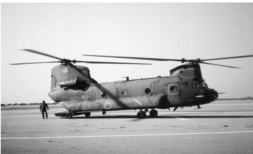
米国ボーイング社が開発したタンデム・ローター形式の大型輸送用ヘリコプターCH-47Dと同等の規模の機体である。CH-47シリーズは米陸軍の主力大型ヘリコプターとして1962年から就役し、700機以上運用されている。そのほかカナダ等多くの国で180機以上
