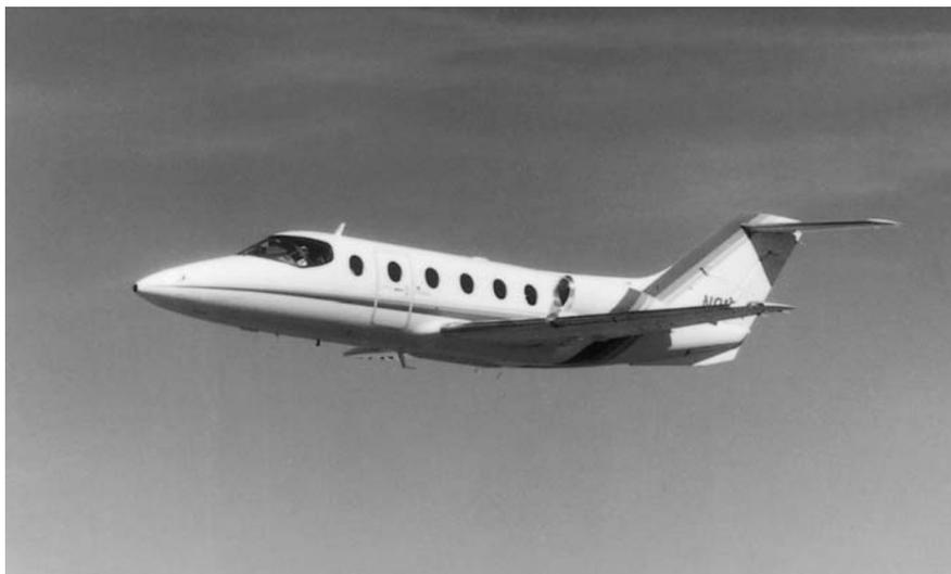
三菱重工が独自に開発したMU-300はMU-2で築いたユーザのステップアップを狙って開発され、ビーチ社が製造権を買い取って販売したビジネスジェット機である。MU-2と同じく全翼幅にわたるフラップと独特の設計による新型翼の使用により、三菱の伝統である高速性と低い着陸速度の組み合わせを可能にしている一方、ビジネス・ジェット機に対する快適な居住性の要求にこたえるため、このクラスで最も
