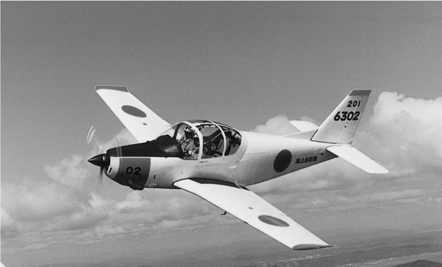
T-5は、海上自衛隊の初級練習機として海上自衛隊の委託により富士重工が製造した機体である。山口県小月基地において運用されている。本機は、富士重工製KM-2型機の後継機であり、富士重工がライセンス国産したT-34メンターをルーツとし、LM、KMと成長した系列の機体である。富士重工はあらかじめ社有機KM-2Dにおいてター
