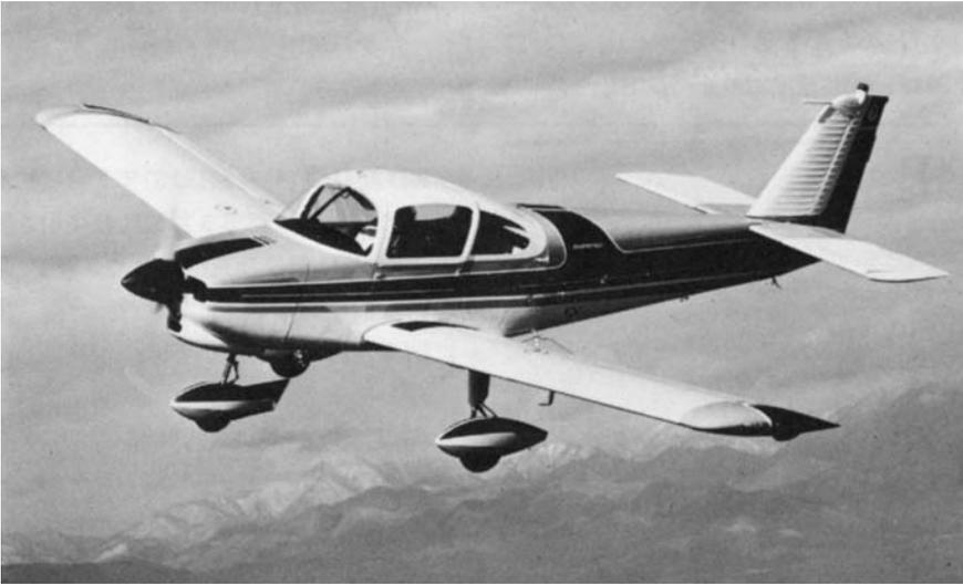
富士重工が開発した、4人乗り軽飛行機で、旅行、スポーツそれに曲技飛行までできる万能型である。主翼や尾翼の大きさ、舵の大きさ、翼型や舵の断面、主翼と尾翼の関係位置、胴体の線図などは同社の過去のデータをもとに決定された。しかも、ほとんど絞り加工を必要としない円筒や円錐の一部
