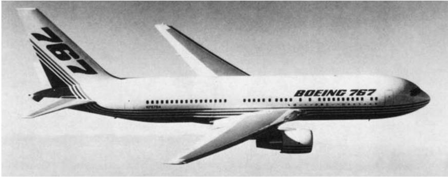
ボーイング767の特徴を要約してみると、省資源という現代社会の一般的な要求に応える低燃費と長寿命性、先端的なアビオニクスの広範囲な採用による技術革新、世界で最も厳しい基準にも適合できる低騒音性、短い滑走路での運用を可能とする優れた離着陸性能、2本の通路を持つ客席による快適性および安全性の確保などを挙げることができるが、1980年代はもとより1990年代にも又はそれ以降にも十分に活躍を続けることのできる近代性をもつ機体を目標に設計されている。
