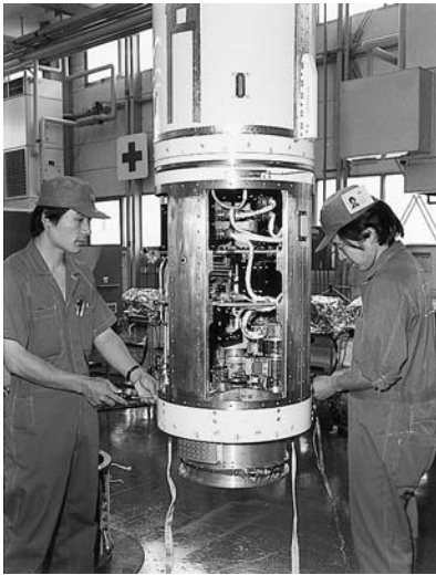
TT-500Aロケット頭胴部の組み立て
