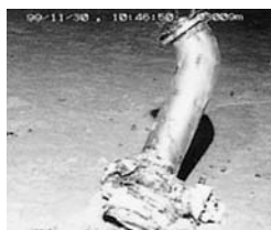
機体バルブ付配管
