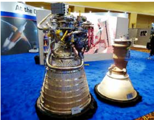
RL-10エンジン（実物）と3Dプリンタで製造したエンジン
