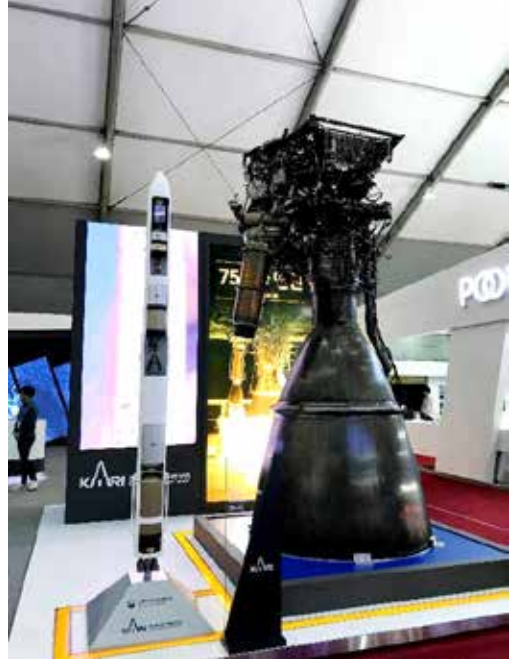
Hanwha KRE-075 GGエンジン (LOX/Jet A-1) NURI (KSLV) -IIの1, 2段用に開発中
