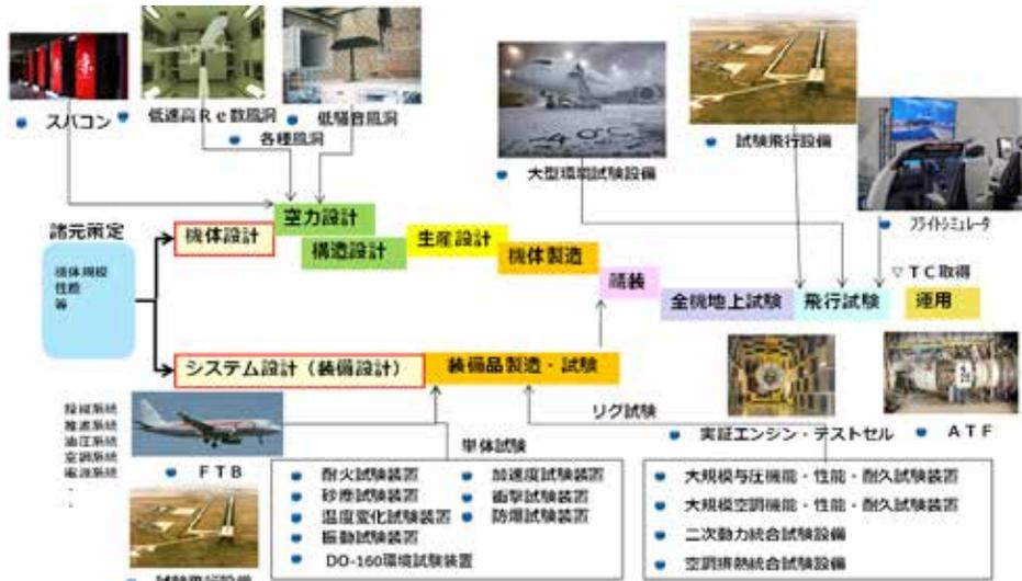
図1 航空機開発に必要な試験設備
