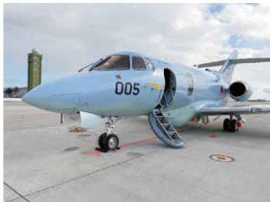
胴体下部、主翼付け根付近の膨らみが 捜索用レーダーアンテナ
