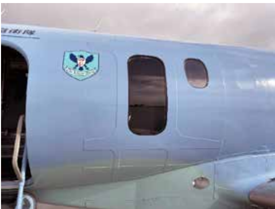
側面の大型捜索窓（外観）
