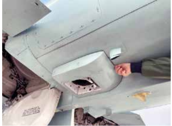
救難用火工品の投下口（左側の脚収納庫内には救命用援助物資投下口がある）
