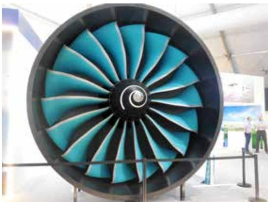
ロールス・ロイスが出展した燃費効率の高い次世代ターボファン・エンジンの実証機「ウルトラファン」の実大パネル
