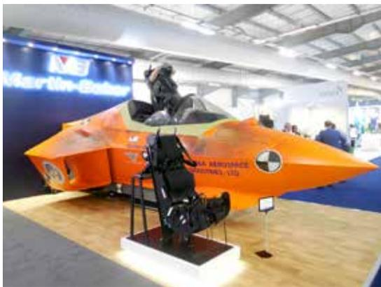
マーチンベイカーが出展したKF-21「ボラメ」用の射出座席と、射出座席の試験に使用したKF-21の前部胴体
