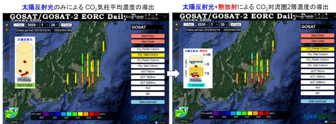
図6：GOSAT/GOSAT-2による対流圏2層濃度測定結果（©JAXA 事前配布資料より）
