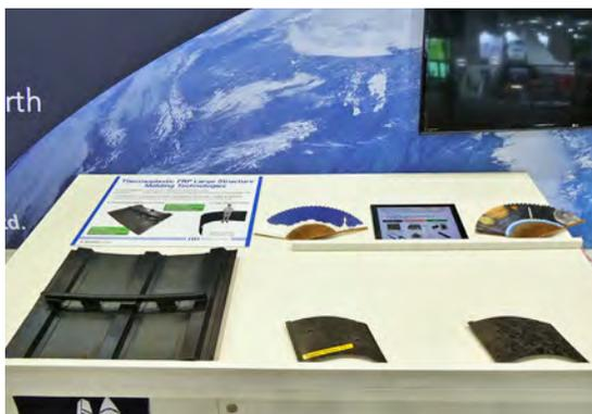
熱可塑性CFRP構造パネル、
