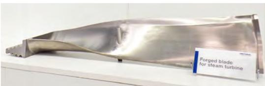
蒸気タービン低圧ブレード
