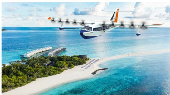
JEKTAの飛行艇にゼロアビアの燃料電池システムを搭載 (提供：ゼロアビア)
