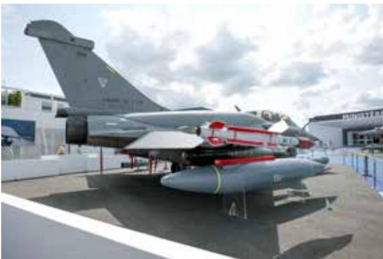
ラファールF5のデコレーション機。胴体上部にはコンフォーマルタンクが付けられているが、これ自体は飛行に使用できないモックアップとのこと。主翼下には新しい電子線ポッドESJが展示されている。
