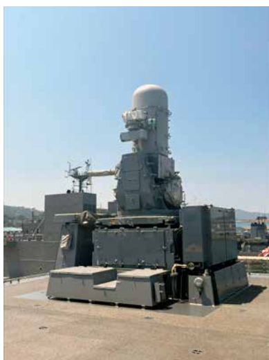
CIWS（近接防空システム）ファランクス：Raytheon製、オーバーホールはIHI
