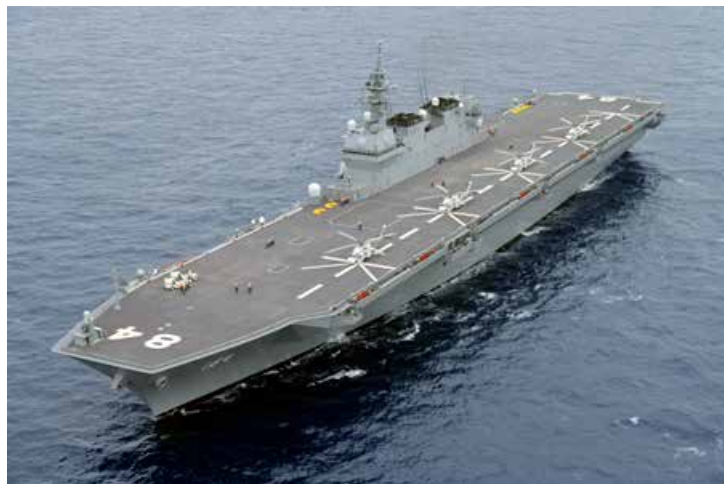
改修前の艦首形状（海上自衛隊HPより）
