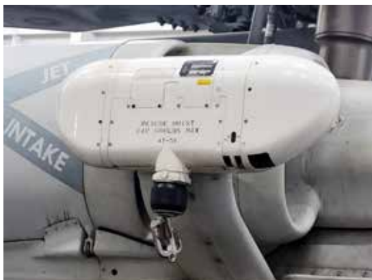
SH-60J用RESCUE HOIST：シンフォニアテクノロジー製
