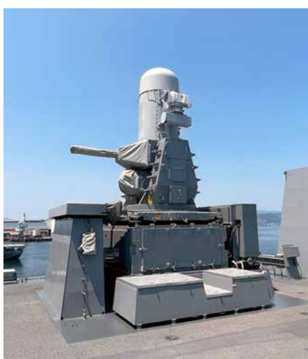
CIWS（近接防空システム）ファランクス：Raytheon製、オーバーホールはIHI
